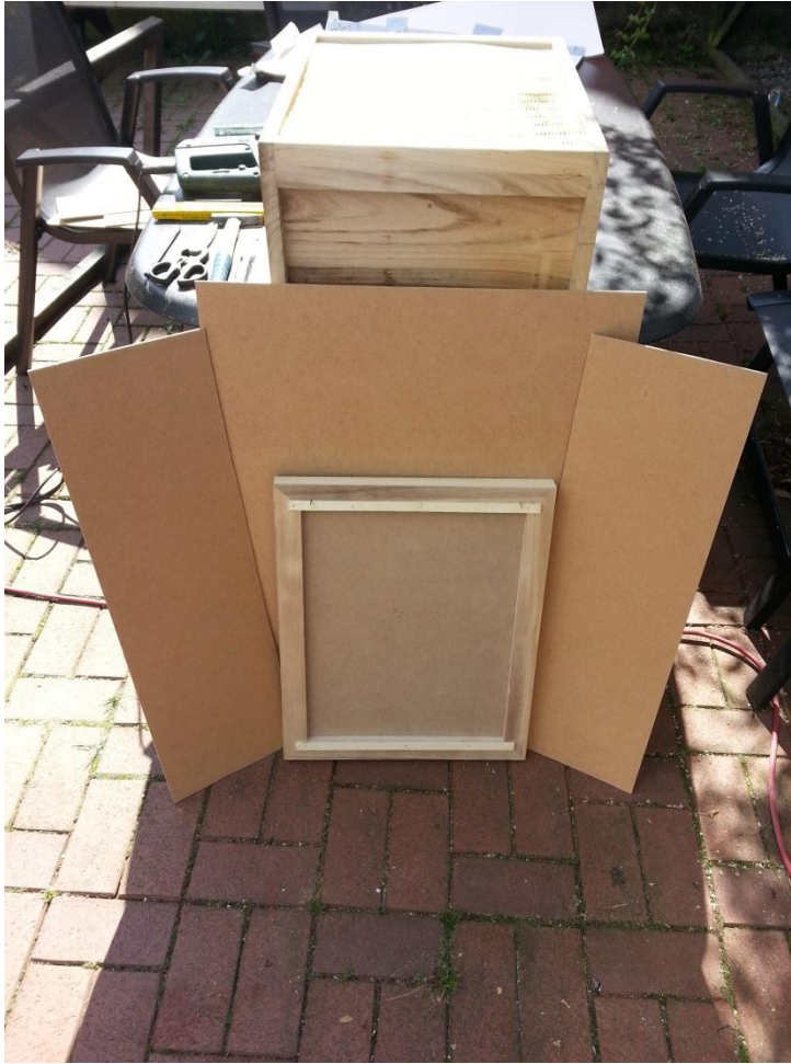
zugeschnittene Seitenteile und Deckel aus Holzfaserverwerkstoff
